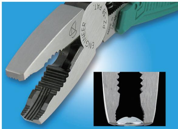
ドライバーでは外せなくなったネジを取り外す場合、ネジ頭にヤスリなどでマイナス溝を作ったり、新たな溝を作るしか方法がなく、それでも完全には外せないことが多かったが、ネジ頭外周を挟んで使用するため、ネジ頭の潰れ方に関係なく衝撃なども与えずにネジを外すことができる。最近、増えている頭の低いネジ（トラスネジ）にも対応できる。
