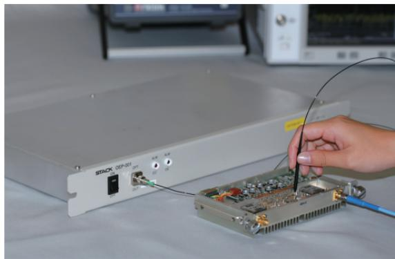
電気光学効果を利用し、電波などの高周波電界の情報を光信号で取り出し、可視化を可能とした電気光学効果電界プローブ。従来の金属プローブと異なり、測定対象の分布に影響を与えないため、正しい姿を見ることができる。特にシミュレーションでしか見ることができなかったアンテナ放射器の近傍電界の姿が擾乱されることなく観察できる。プローブセンサーは空間分解能の向上と微小な空間への挿入を意図し、小型化・微小径化を図り、検出チップ寸法で約 $230\mu\text{m}$ 角の完全メタルフリーな構造を実現した。
