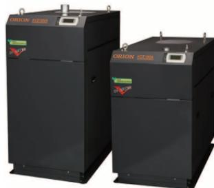
オリオン機械のパッケージ型省エネ真空ポンプ「インバータベーンレス真空ポンプ」は、回転するローターにベーン（ブレード）が付いたロータリーベーン方式の真空ポンプに比べて、同じモーター出力で流量を45%向上した。独自のインバータ制御によって消費電力も従来機比で54%削減した。
