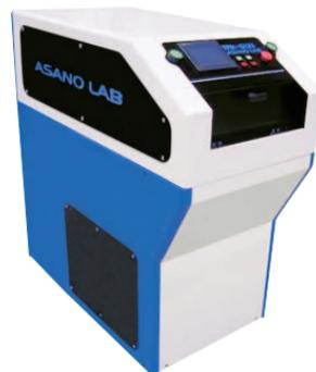
浅野研究所が開発した「熱板式被覆成形機ならびに成形同時トリミング技術」は、基材（金属あるいは樹脂成形品）にシートをかぶせながら接着する一体成形技術だ。凹凸感のあるシートもその立体感を損なうことなく成形でき、携帯電話、家電、自動車製品などのデザイン性を大幅に向上できる手法として注目されている。
