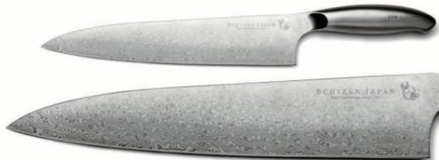
「コアレス積層鋼」は、成分バランスの異なる高品質なステンレス刃物鋼2種類を交互に重ねて、圧延加工による異種金属接合技術を用い、分子間レベルで接合させた鋼材。1層は厚さ約30-40マイクロメートルと薄く、多積層化する製造過程によって、炭化物が微細化されてバランスの良い組織を形成し、強靱性<sup>きょうじん</sup>も高めることができる。
