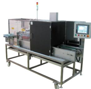
ナベルは孵（ふ）化途中卵検査装置「EVS400」で、業界で初めて腐敗卵や発育中止卵を検出できるようにした。心拍や拍動などの生体信号を検出することで、正常成育卵の検出精度は他社従来機の9割程度に対して99%超まで高めた。インフルエンザワクチンの製造工程などでの生産性向上に貢献するとして、活躍の場の拡大が期待される。
