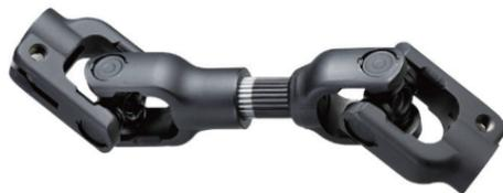
協和工業が開発した常時摺動シャフトは自動車のハンドルの動きをタイヤに伝える部品で、電動パワーステアリング（EPS）システムに搭載されている。ジョイント（継ぎ手）メーカーの同社は長年培った冷間鍛造による成形技術に、薄膜樹脂のコーティング技術を組み合わせることで新方式のシャフトを完成。ジョイントとのセットでハンドルの操作位置の調整や、自動車の衝突安全性の向上などで効果が期待されている。
