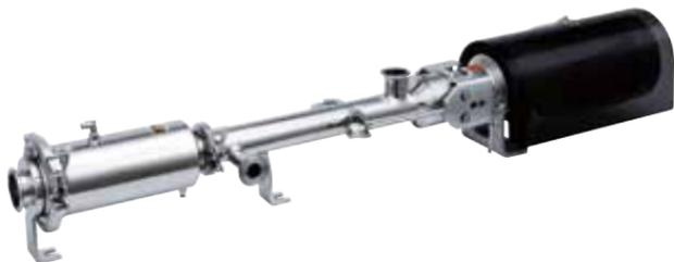
兵神装備が開発したポンプ「SIP対応ヘイシンモノポンプNHLA」は、高まる食品業界への安全要求に対応できる。多種多様な液体を扱う食品業界では、無脈動や定量移送が可能で、液が変質しにくく、汎用性の高い一軸偏心ネジポンプ（PCポンプ）が頻繁に使われる。だが従来のPCポンプは、構造上、高温の蒸気でポンプ内を含むプロセスラインを一定時間高温に保ち滅菌するという用途（SIP用途）に対応できなかった。
