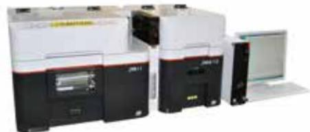
有機微量元素分析装置JM11型は、国産では唯一、炭素水素分析法であるPregl法と窒素分析ではDumas法を組み合わせ、水素、炭素、窒素の3元素を同時に分析する。
