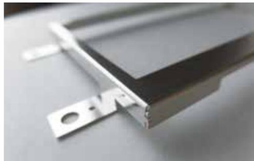
箱型形状のコーナー部の曲げ加工には、通常、溶接やねじ止めが使われているが、工程数が増えればコスト増加などの問題が発生する。ソルテックは接合部分の形状を工夫することで、プレス加工のみで筐体を製作する加工技術を開発した。
