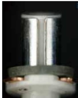
スマートフォンなどに組み込まれる振動モーターの心臓部である整流子の組み立てについて、自社製の全自動機を利用した新技法「円筒先端カシメ工程」を確立した。従来品に比べ価格は同等ながら、振動モーターの寿命は5倍を実現している。従来品は、樹脂ホルダーに金属片を貼り付け、その下部をワッシャーで固定する方式だったが、それに1工程を追加。上部を樹脂で溶着封止することで金属板の剥離を起きにくくした。これにより連続耐久試験による稼働時間は、従来品の100時間から500時間に長寿命化した。
