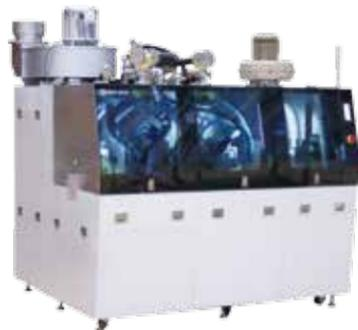
熱間加工や焼きなましなどの熱処理を施した鋼材の表面には、黒皮と呼ばれる硬い酸化スケールが発生する。同社が開発した装置は「ウェットブラスト」と呼ばれる物理的な技術を活用して棒鋼材の酸化スケールを除去する。
