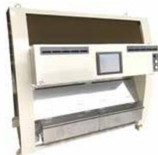
目視では判別できないカビなどの菌被害粒を検出して自動除去する選別装置。深紫外線発光ダイオード (DUV-LED) と、相補型金属酸化膜半導体 (CMOS) カメラ、コンタクトイメージセンサー (CIS) を活用して実現した。
