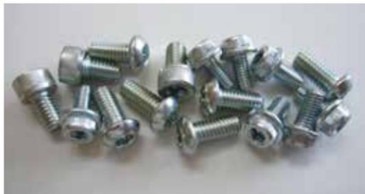
多機能緩み防止ねじ「モーションタイト ハードタイプ」は、ねじ径がM2-M3程度の小径ねじに対しても、緩み防止力があるねじ。ねじ山の形状を工夫して、左右非対称にすることによって、通常のねじと同じように締め付けるだけで緩みを抑えることができるのが特徴だ。疲労強度は、従来のねじの約1.2倍ある。
