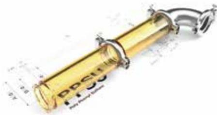
透明で耐熱性が高く、薬品や衝撃にも強いスーパーエンジニアリングプラスチックであるPPSU（ポリフェニルスルホン）を原料に使用したサニタリー管。食品や医療品などを生産する工場では、異物混入などを防ぐため製造過程を可視化する必要があり、配管の一部が透明なガラス管になっているケースが多い。ガラス管の場合、衝撃で破損するとガラス片が食品などに混ざってしまう危険があるが、PPSUサニタリー管は樹脂製のため、衝撃で破損することはなく安全だ。
