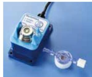
マイナス200mmHg（水銀柱ミリメートル）から800mmHgの連成圧測定ができる使い捨て型の圧力センサー。電子部品を有するアンプ部とダイヤフラム部を分離した構造で、ダイヤフラム部は使い捨て可能。取り付けはダイヤフラム部のナットを回すだけで容易にできる。透析業界や分析装置、対外循環回路部材向けに販売する計画。価格はアンプ部が8万円、ダイヤフラム部が注文数に応じて1個当たり1000円から3000円。
