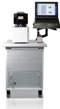
「非接触レンズ中心肉厚測定機 CT-Gauge」は、光学レンズの中心肉厚を非接触で測定する装置。中心肉厚の設計値からの誤差は、像がボケるとか歪むといった光学収差の増大につながる。しかし、中心肉厚は、図面には記載されているものの、その検出が難しく、測定方法が確立していない。一般的な測定方法は接触式で行われるが、レンズ表面に傷がついてしまう課題があった。本装置は1点しかないレンズの中心肉厚を非接触で高精度に測定することを可能にした。
