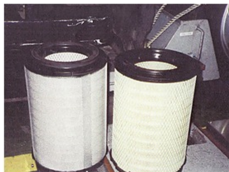
エレメント（左＝純正、右＝セラミックフィルター）
