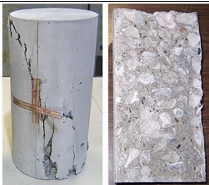
石炭灰を活用したコンクリートの材料試験
