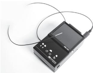
肉眼で直接のぞけない穴や管の中を観察する内視鏡はビデオカメラ型とファイバースコープ型に大別される。SPIエンジニアリングが手がけるのは前者のビデオカメラ型で、工業用を主力とする。今回の受賞製品は直径1.8mmの内視鏡先端部にイメージセンサーを使用した超小型カメラを内蔵し、ポケットサイズの専用モニターやパソコンに画像を表示する。ビデオカメラ型内視鏡として「業界最細を実現した」（同社）という自信作だ。
