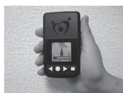
加藤電機は、認知症高齢者の徘徊や子どもの誘拐・連れ去り対策として、見守りサービス「SANフラワー」を開発した。携帯電話やGPSなどの公衆回線を使わず、920<sup>MHz</sup>の特小電力帯の電波を直接検出する。アンテナと探索レーダー、発信機の三つの送受信機を用意した。月額利用料は無料。地域に暮らす個人や法人、自治体などが協同参画することで、地域の安全を地域で守る仕組みを構築できる。
