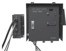
「白濁排ガス用ノンサンプリング瞬間気化式ダスト濃度計」は、ボイラや焼却炉などから排出される水分を大量に含んだ排ガス中のばいじん（ダスト）濃度を連続測定できる。
