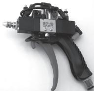
アルプスエアは、空気圧のみで制御回路を構成する「CVシリーズ制御弁」と、この制御弁を応用した「自励発振回路」、「パルス噴射エアブローガン」を開発した。一連の応用製品のベースとなる新型制御弁「CV」は電気信号を使用せず、空気信号で弁の切り換えが可能なエアパイロット式。空気圧だけで動作を行う全空制御回路はスペースが半分程度で済むうえ、電源不要（空気源の接続だけ）で、電気ノイズを発生しないなどの特性がある。この制御弁を用いた「自励発振回路」はわずかな外付部品（速度制御弁など）で構成でき、毎秒10回程度からの高速発振から、1分に1回程度の低速発振まで可能としている。発振回路は空気供給をON/OFFすることで起動と停止を行える。
