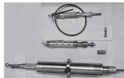
アピュアンが開発したエア工具「ワンショットパンチャー」の特徴は、従来の振動工具の連続動作を1回ずつの打撃に変更したことだ。連続打撃では振動や騒音で作業への負担が大きくなる傾向があり、労働環境の改善に課題があった。自動車業界などで用いるピン類の打ち込み作業を1打撃ずつできれば、振動と騒音が抑えられ、振動障害の予防も期待される。
