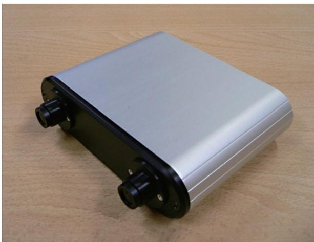
図2 ステレオカメラ カメラの間隔は8cm
