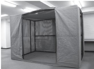
日本エレテックスが開発した「イキソルメッシュ」は特殊極細金属糸を使い、広帯域にわたる高い電磁波遮蔽（シールド）性能を持たせた金属布。金属でありながら柔らかさと強度を持つうえ、内部が透けて見える視認性も満たしている。既存の鉄板製シールドボックスは高価で、重くて持ち運びが難しかった
