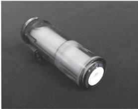
トックベアリングが開発した「トルク可変多回転ダンパー」は、主に自重落下式のブラインドのブレーキ部分に使用して動作音を抑える。オイルダンパーを採用し、他社従来品で必要だった歯車増速機構と遠心ブレーキ機構を持たない。そのため、ブレーキ単体ではほとんど音がしない。また、部品点数を他社従来品の12点から8点に削減し、自社工場で内製できることで製造コストを抑えた。
