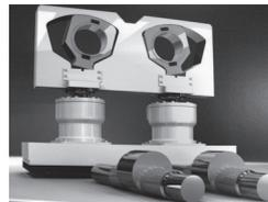
太陽工業は精密プレス部品や精密プレス金型などの製造を主力とする。その同社がユーザーの目線から自ら開発したのが「2ポイントサーボプレス」（加圧能力は6,000キロニュートン）。クランク機構のコンロッド（連接棒）に代えて、独自考案した扇型支持ロッドを搭載することにより、従来構造のプレス機に比べ精度、剛性を大幅に高めた。
