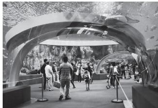
日プラは、高品質の水槽用大型アクリルパネル「アクアウォール」を製造し、国内外を問わず現地施工まで一貫して請け負う。水槽用大型パネルの分野では世界シェア7割で、納入実績は60カ国以上。納入先は水族館や動物園、テーマパーク、大型商業施設など幅広い。多数の来館者が集まる水族館などの水槽では、観賞用としての機能を損なわない高い透明度と水槽自体の耐久性を両立させることが求められる。最大のポイントはアクリル板の積層技術。重合接着作業は独自ノウハウをもとに行い、重合反応を完結させる。アクリル板を何枚重ねても透明度と強度が落ちない仕上がりを実現している。
