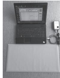
就寝時の安心をサポートする。細田が開発した「呼吸・体動ワイヤレスモニタリングシステム」は介護施設を主な用途とし、ベッドフレームとマットレスの間に設置したセンサーの動きで呼吸状態や寝返りなどの体位変化を計測する。呼吸停止や多呼吸、呼吸数低下などがあれば、警報で異常を知らせる。呼吸・体動など生活リズムの情報を日々蓄積するため、睡眠時無呼吸症候群の監視や生活習慣病の予防対策にも応用できる。
