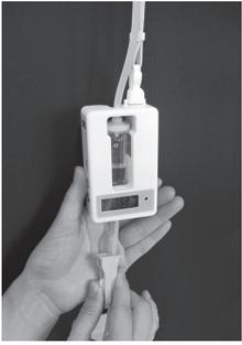
「点滴センサ IDC-1301」は点滴スピードを的確に測定する。病院などの医療現場で、看護師の点滴セットの支援ツールとして開発された。秋田県産業技術センターなどとの連携で、センサ制御技術を高度化し、点滴筒が傾いた場合でも計測可能にした。滴下間隔を測定し、1分間あたりの滴下数や1時間あたりの流量を液晶表示部に表示する。一般に病院で使われる輸液セット滴数（1ミリリットルあたり20滴と同60滴）をスイッチ一つで変えられる。
