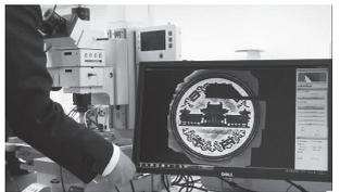
「Hybrid Measure」は顕微鏡で得られた画像を張り合わせるタイリングを高速で行うソフト。マニュアルでステージを移動するだけで、分割して撮影された画像をXYZ方向に張り合わせ、高倍率で広視野の画像をリアルタイムで生成する。画像をパノラマ状に合成する操作は手元のマウスで対象を走査する感覚で行える。製品のスクリーニング検査に用いる場合、欠陥を見逃す可能性が低くなり、必要に応じて部品を拡大して高解像度の画像で手軽に確認できる。
