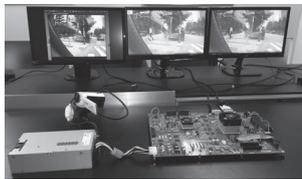
「SMYLEvideo (Gen-2) メニーコア」は多数のコアで構成される画像認識用CPU(中央演算処理装置)。世界最速レベルの画像認識速度と低消費電力を両立したのが最大の特徴だ。車載カメラに組み込めば、歩行者や自転車を即座に認識できることから、「車の自動運転」関連で顧客開拓を目指す。
