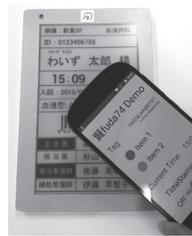
表示の保持に電力を消費しないE-INK(電気泳動)方式の電子ペーパーディスプレイパネルを採用し、無線識別(RFID)タグの内容を可視化する。無線で給電と書き換えを行う2.7インチパネルタイプと、2次電池を備えて書き換えの応答性を高めた7.4インチパネルタイプを用意。両タイプはいずれも近距離無線通信規格の一つで汎用性が高い「NFC」を利用しており、市販のリーダーライターで表示を書き換えられる。
