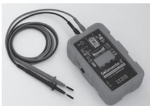
アイテスは、太陽電池パネルの出力低下など故障を発見する検査器「ソラメンテ」シリーズを開発した。日射量や天候の変化による影響を受けずに、短時間で故障パネルの位置を特定できる。メガソーラーと呼ばれる1000\*<sub>0.7</sub>級の大規模太陽光発電所（パネル数は約4000枚）でも半日以内に検査を終えられるという。
