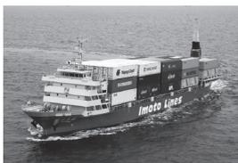
「ふたば」は内航コンテナ船初の電気推進船として2014年12月に就航した。京浜港と阪神港を拠点に北海道、東北、中部、瀬戸内海、九州を結び、内航フィーダーコンテナ輸送に従事している。「従来のディーゼル船に比べ格段に静かで振動も少なく快適。離接岸時の操船も楽になった」(長嶋大介船長)とメリットを強調する。
