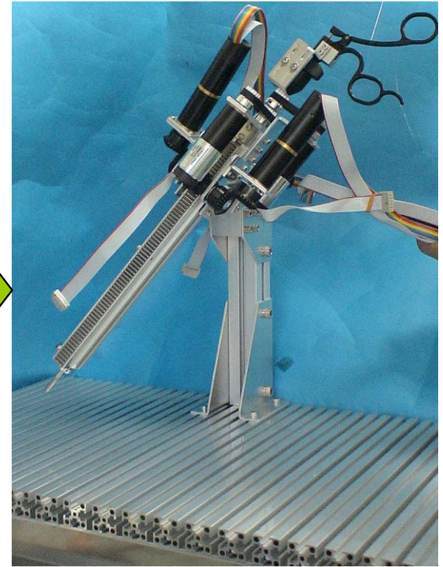
スレーブシミュレータ 生徒が鉗子の動作を見たり 触れたりする
