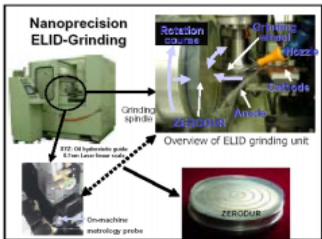
本日ご覧いただきますが、結構大きな非球面加工装置で、1メートルぐらいの長さの鏡の加工ができる E L I D 加工機も開発されています。大型なのですが、ナノ精度に近づけたいという需要がかなり出て
