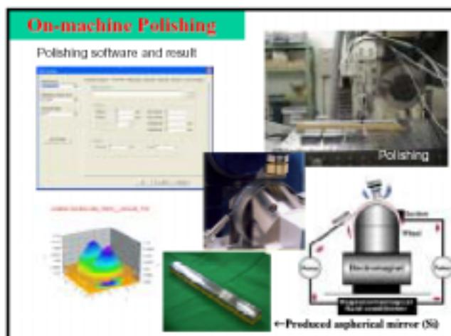
本日ご覧いただきますが、非常に面白く興味深い技術なのですが、流体、液体を利用した研磨技術があります。その液体は、磁石に反応する磁性流体という液体を用いまして、要は、鉄粉と砥粒が流体の中にいわば分散したようなものです。この磁性流体が、回転するマグネット、つまり磁石の表面に張り付いて、ある一定の膜圧で回転する訳です。その回転するマグネットに張り付いた流体の膜で磨くという非常に面白い技術で、主に光学部品を磨きます。部品のどの部分をどれだけ磨くかというプログラムを、形状を測定しながら作り、部分的に修正を進めることができます。これですと10分ぐらいで60ナノ以下の誤差にするとか、チャンピオンデータですとその半分ぐらい、30ナノぐらいの誤差に入れるとか、ちょっと、最初は我々も信じられなかったような精度が、こういう流体で磨くということでき始めております。これも、E L I Dと組み合わせるともっと良いということで、それをシステム化して実用化、普及させようと考えております。
