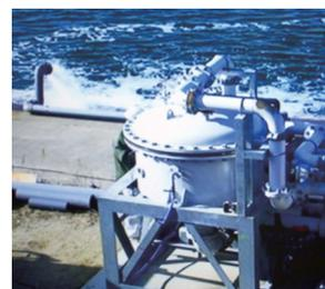
「洗浄機能を有する大型ばね式フィルター」は、逆流洗浄から再度精密濾過を行うまでの過程が自立して行われるため、保守管理に人手がかからず低コストで利用できる。高温、高圧、高濃度薬液など特殊な条件での濾過にも対応する。
