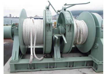
小浜製網の高強度ロープ「クエストライン」は織物構造を採用することで構造的な強度を生みだし、高耐久性や高耐摩耗性を実現。直径が同じであれば、引っ張り強度は一般的なロープの約2.5倍と大幅な強度向上を図った。船舶の係船や荷役作業などに活用すれば、軽量化による作業人員の削減や作業負担の軽減、作業環境の安全性向上などの効果が期待できる。係船に採用する大手フェリー運航会社は、使い勝手が良く安全な作業が確保できているとして、採用拡大を進める計画だ。
