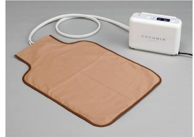
ライト光機製作所が開発した「循環式冷却・加温シート装置」は、設定温度に保たれた循環液を流すことで、「冷やす」あるいは「温める」ことができる厚さ4ミリのシート。シートは内部の立体的編み物構造の間を循環液が流れる原理で、シートが折り曲げられたり踏みつけられたり、直立した状態であっても、安定して循環液が流れる仕組みを実現した。これにより、シートを設定した温度にいつも保ち続けることができ、医療・介護現場や個人ユースでの「冷やす」「温める」というニーズを簡単に満たす装置を実現した。
