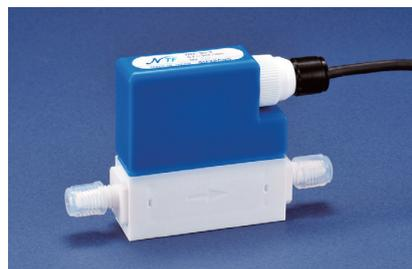
サーパス工業の「タイムオブフライト式微小流量計」は、差圧式や超音波式の流量計では測定できない毎分30 $\mu\text{L}$ 以下の微流量レンジを測定できる流量計。毎分0.1 $\mu\text{L}$ ～3 $\mu\text{L}$ と、同0.5 $\mu\text{L}$ ～15 $\mu\text{L}$ の液体流量について正確で安価に測定できる。現行の微小流量計に比べ、大幅に小型化し、設置場所も省スペースですむのも特徴だ。
