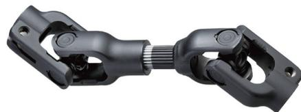
協和工業が開発した常時摺動シャフトは自動車のハンドルの動きをタイヤに伝える部品で、電動パワーステアリング（EPS）システムに搭載されている。ジョイント（継ぎ手）メーカーの同社は長年培った冷間鍛造による成形技術に、薄膜樹脂のコーティング技術を組み合わせることで新方式のシャフトを完成。ジョイントとのセットでハンドルの操作位置の調整や、自動車の衝突安全性の向上などで効果が期待されている。
