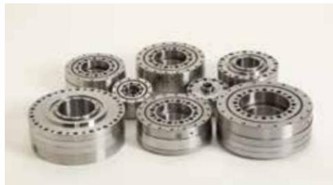
SKGの精密減速機は、小型・シンプル構造かつ高精度・高耐久の新方式減速機。一体のフレックスギアを減速部と出力部に分割し、波動歯車の出力をシャフトとカム穴で取り出す独自構造により、フレックスギアの均等な加工が可能になった。出力トルク・座屈トルクは拡大し、シンプルな部品構成で従来品の半分程にサイズダウンした。
