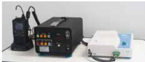
サークル・ワンは、自治体の防災行政無線放送を、住民が所有するスマートフォンなどの携帯端末に直接流すことができるシステムを考案した。「音声の再放送」という考えに基づき、防災放送が受信可能な戸別受信機の音声をイヤホンジャックを通し装置に入力。周波数の異なるスマホにも、防災情報をタイムリーに放送することができる。
