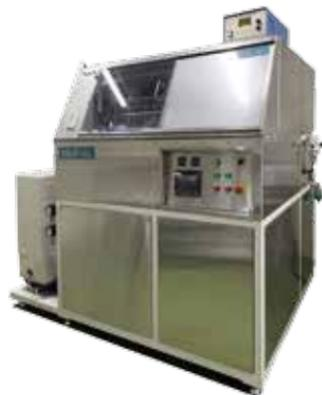
工業用洗浄装置「NEUF (ノイフ) FTR-1型」は、開発した独自の昇降装置を使うことにより、フッ素系の洗浄溶剤の使用量を削減する。同時に、洗浄精度 (付着物除去率) も向上した。洗浄溶剤は従来品に比べ、洗浄タクト6分、1日8時間稼働 (1カ月21日) とした場合に、1カ月で3分の1から4分の1の消耗に抑制できる。
