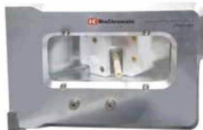
レトロネーザルアロマ計測システムは、常温・大気圧下のコロナ放電による自社開発の新イオン源によって、高感度で香気成分の直接分析を可能にした。レトロネーザルアロマとは喫食時、呼気とともに鼻から抜けていく香りのこと。香気成分をイオン化し、質量分析装置で計測する。
