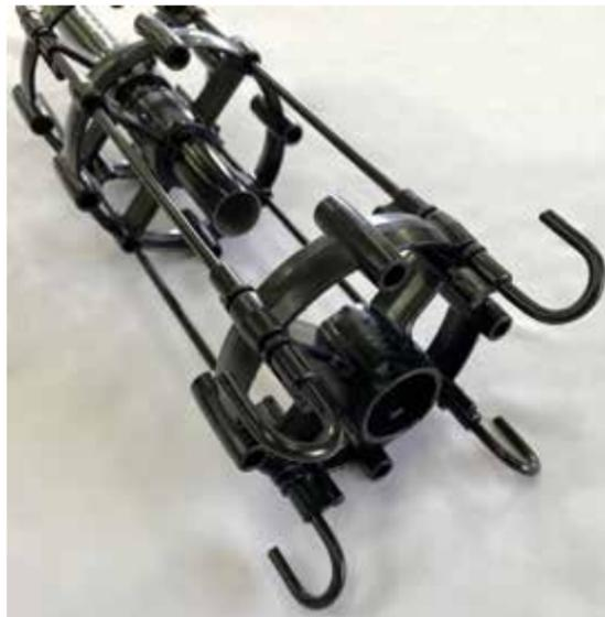
トワロントレーディングは、「錆びない、壊れない」のコンセプトで、バグフィルター式集塵機用リテーナ「ReBorn (リボーン)」を開発した。リテーナは細長い円筒型、ろ布（フィルター）を支えて集塵性能を維持する部材だ。従来のリテーナはカゴ状に金属を溶接して組み立てていた。約2年のフィルター寿命を迎えると、接合部の錆びでフィルターとリテーナが膠着し、リテーナごと産業廃棄物となっていた。
