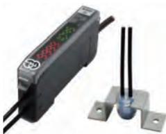
東横化学が開発した「その液体、何ですか『液種判別センサー』」は、耐屈曲光ファイバーを使う新しい検知方式を採用した液種判別センサーだ。漏れた液体の屈折率と色で、その種類を判別する。薬品貯蔵設備の下にたまった液体が、薬品が雨水かを見分け、適切に対処することが可能になる。
