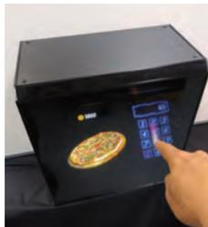
空中映像表示素子パリティミラーと非接触センサー、制御ソフトを合わせた空中映像ユーザーインターフェースモジュール。宙に浮いた画像や映像をタッチパネルのように操作できる技術を実用化した。従来のタッチパネルと異なり液晶ディスプレイには手は触れない。
