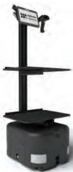
ヒト協働型ピッキングアシストロボット「ラピュタPA-AMR」は、倉庫の集荷で作業員に最適経路を提示し、自ら移動しながら棚から下ろした商品を運ぶ。内蔵センサーで周囲の状況を把握する仕組みで、クラウドによる複数機の同時運用で空走時間を減らし、ミスも低減する。累計導入台数は150台を超えた。
