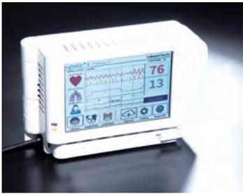
サクラテックが開発したレーダー心拍・呼吸センサー「miRadar8 Handy」は、非接触で心拍、呼吸、体動などの生体情報を検出する機能を持つ小型携帯型の装置。医療・介護だけでなく、日常の健康管理、ペットなど動物の生態情報計測にも用途を拡大できる。
