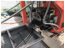
産業廃棄物の架橋ポリエチレンを資源循環する技術を確認し、事業化に取り組んでいる。架橋ポリエチレンは再利用が難しく、サーマルリサイクルの燃料として利用するか、埋め立て処理するのが一般的だ。同社の技術が広まれば、架橋ポリエチレンのリサイクルに新たな選択肢が加わる。
