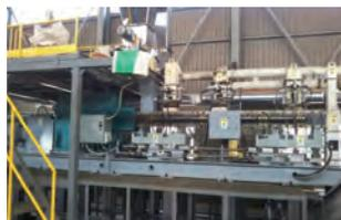
食品工場などで排出される高水分のバイオマス系廃棄物、使用済みプラスチックをバイオマスリッチの割合で混合して熱分解することで、石炭やバイオマス燃料の代替として使用できるカーボン燃料を作る。2軸押出機で、350〜500度C以下の定温熱分解で生産した固形炭化物は、石炭やバイオマス燃料の代替として発電に使用できる。
