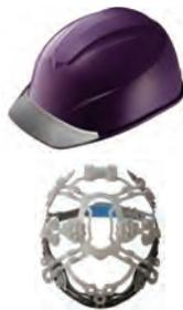
谷沢製作所の産業用ヘルメット「123シリーズ」は新内装体「エアライトS」を採用し、従来品比で約15%軽量化、コンパクト化したのが特徴だ。ヘルメット内部には飛来・落下物に対する衝撃を吸収する樹脂製内装体を取り付ける。従来の六角柱形状で支持していた構造を、独自開発したハニカム構造の支持ブロックに変更。ヘルメット外装部（帽体）と内装体との隙間（頂部隙間）を大幅に減らしたことで、軽量化を実現した。
