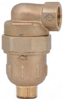
ゴミ噛み防止型吸排気弁「NAV-ODC4」は、中高層建物の給水立管の頂部に取り付ける給水用具。従来の機能はそのままにゴミ噛みが発生しにくい構造にした。動作テストを100回行なって1回もゴミ噛みが発生しないほどの高性能を実現した。水道給水用ポリエチレン管の設備配管に最適。また外部排水カバーが回転し、配管時に排水配管の位置合わせが容易になったほか、従来比30%の軽量化とコンパクト化にも成功した。
