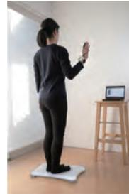
UNTRACKEDの転倒リスクがわかる立位年齢計測装置「StA<sup>2</sup>BLE」は、指先への感覚刺激と人工知能（AI）技術により、転倒リスクを客観的に数値化して評価するシステム。指先に振動デバイスを装着して目をつむり1分間、立った状態のまま計測するだけで転倒に対する強さを「立位年齢」として示す。
