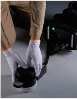
アーキヤマデが開発した「EM-6」は、屋外防水工事の施工管理を高度化する誘導加熱装置。施工品質を向上するだけでなく、作業データをログとして記録し全地球測位システム（GPS）の位置情報とも付けることで建築のDX（デジタル変革）化を進めることができる。
