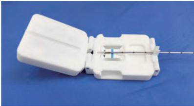
ウミヒラは、病理検査や遺伝子検査のために腫瘍などから採取した微小な生体組織を縦軸方向に分割する「組織2分割デバイス」を、京都府立医科大学の浮村理教授と共同開発した。縦方向での分割により同一検体を病理検査と遺伝子検査
