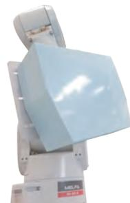
画像認識による外観検査の自動化は長年、生産現場の関心を集めてきた。しかし表面に光沢があると光が反射し、正確に検査ができない場合も少なくなかった。マクシスエンジニアリングの「ホロ照明ユニットMHA-P30」は、光沢がある表面でも反射光に惑わされず表面の平滑度や微細な傷が識別できる外観検査用の照明。ロボットアームの先端に搭載し、目視に頼っていた外観検査を自動化できる。
