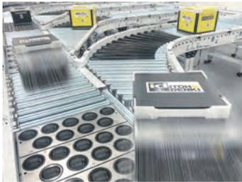
生産現場や物流業界で使用されるコンベヤーで、搬送物を分岐する際に使用する装置。複数の球状のローラー（ボール）で構成され、搬送物を左右、ななめ、直進と任意の方向へ仕分けすることができる。制御されたボールの首振りでフラットな仕分け搬送をするため、1時間に6000ケース、小物であれば
