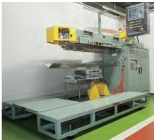
ムラタ溶研が開発した「極薄長尺板の水平自動溶接装置」は、薄くて長いステンレス板材を円筒形状に加工するための高精度な突き合わせ溶接ができる。配管設備などに使う伸縮管継ぎ手（ベローズ）は用途に応じ、多様な条件が要求される。同社は厚さ0.15ミリメートル、長さ1000ミリメートル、径100ミリメートルサイズの板材の端面を、加圧密着させる独自のワーククランプ（把握）機構を採用した。2段階の加圧密着で溶接部位のすきまをなくした後、トーチ先端部が円弧を描く動作をしつつ水平移動し、高品質のTIG（タングステン不活性ガス）溶接を自動で行う。
