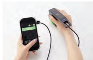
ハンディタイプのプラスチック材質判別装置「ぶらしる」は、読み取りセンサーを内蔵したセンサー部と判別結果を表示するタブレットで構成する。対象物に近赤外線を照射し、反射した光の波形をもとに材質を測定する。測定した波形データを、登録済みの12種類のプラスチックの波形データと照合して、最も波形に近い材質をタブレット画面に表示する。熟練者の経験に頼っていた判別業務を、誰でも簡単かつ同じ基準で安全に行える。
