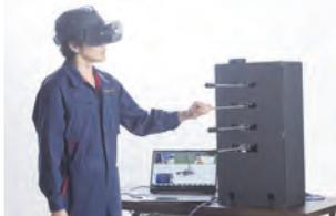
日本初の小型移動式クレーン専用の訓練用VR（仮想現実）システム。操作環境を忠実に再現して臨場感のある3次元CG（コンピューターグラフィックス）表現や、物理シミュレーションによる重力や衝突などによりリアルな操縦環境を実現した。基本的なクレーン操作や試験コースを忠実に再現するだけでなく、「荷揺れ」の制御に特化した練習などVRでしか再現できない訓練メニューも用意した。初心者から経験者まで幅広く利用できる。
