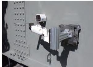
陽電子寿命測定法は金属疲労や高分子劣化などを原子・分子レベルで高感度に検出することができることから、材料研究における分析手法の一つとして利用されている。東洋精鋼は産業技術総合研究所との連携により、陽電子寿命のオンサイト測定技術の開発に成功。
