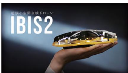
「IBIS2」は、屋内での施設点検用途に特化した小型軽量の飛行ロボット（ドローン）。天井裏や配管など人が入り込めない狭い空間を飛行でき、墜落、衝突しても設備を傷つけづらい。狭い、暗い、危険な空間の点検業務をドローンに置き換
