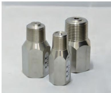
超多段オリフィス型スチームトラップ「Steam-Z Sシリーズ」は他にないユニークな製品。可動部を持つスチームトラップに比べて経年劣化や故障が極めて少ないのが特徴だ。連続的に凝縮水（ドレン）を排出するため、間歇排出型に比べてスムーズに機能する。同社ではオリフィス孔径の種類を増やし、シリーズを充実している。
