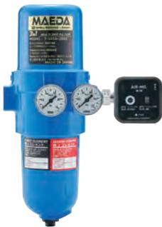
「AIR-MO（エアモ）」は同社製フィルター「3in1マルチ・ドライフィルター」専用の圧縮空気品質モニター。3in1マルチ・ドライフィルターは工作機械や測定器などに用いる圧縮空気に対し、三つのエレメント（濾過紙）を用いて空気内の水・油・オイルミストを取り除き、清浄度を保つ。
