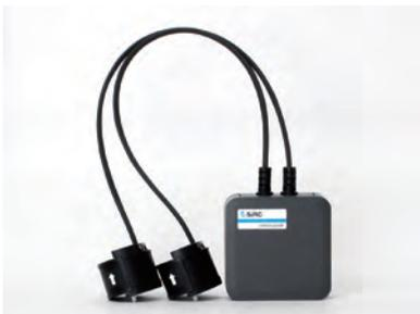
2本の電線に非接触で取り付け、力率を加味した有効電力を測定するIoT電力センサユニット。工場の装置などの三相交流の電力を、3本中2本の線をクランプで挟み最短15秒で取り付けを完了して測定できる。大掛かりな電気工事が不要のため低コストで導入でき、必要に応じた移設もしやすい。電極に触る必要もなく、計器の取り付けのために装置を停止せず
