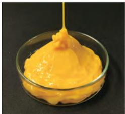
柑橘由来のセルロースナノファイバー（CNF）「MaCSIE」は、世の中になく柑橘由来のCNF。柑橘王国愛媛で発生する柑橘加工残さを使用し、環境に優しく、脱炭素化など持続可能な開発目標（SDGs）に貢献する。廃棄されていた柑橘搾汁残さの果皮を原料に、主成分のセルロース繊維を特殊な技術でナノサイズまで細く解繊した柑橘果皮ペーストを使用する。ナノ化されたセルロース繊維の働きで、高粘性、チクソ性などのさまざまな物性を持ち、柑橘由来の有効成分による生理活性がある。
