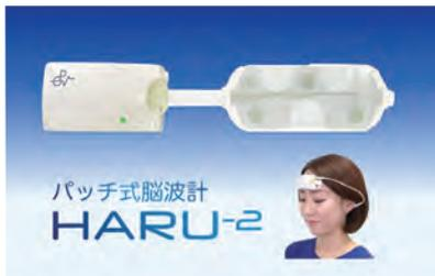
パッチ式脳波計「HARU-2」は、超薄型で伸縮性の高い電極シートを用いた簡易型の脳波計だ。大阪大学産業科学研究所の関谷毅教授の研究成果をもとに開発された。重さ42グラム、大きさが6.7センチ×4.2センチ×2.2センチメートルと国内最小・
