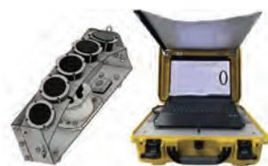
養殖魚の自動尾数カウントシステム「MagicCounter」は、分養時にリアルタイムで尾数を正確に計測できる装置。養殖では魚の適切な飼育環境を保つなどの目的から、一つの生けすから別の生けすに魚を移す分養という作業が行われる。
