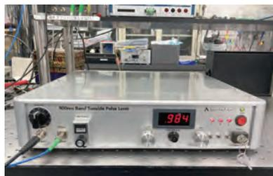
ネオジウムファイバーと半導体レーザーを用いた900ナノメートル（ナノは10億分の1）帯波長可変レーザーを開発した。新たに開発したチューナブルフィルターを採用し、890ナノメートル～930ナノメートルの間で波長を調整できる。発振線幅は0.1
