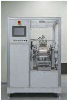
凹面への精密な印刷を実現するスクリーン印刷技術。これまで凹面に対して精密にスクリーン印刷する技術はなく、ディスペンサーやオフセット印刷で対応するしかなかったという。ディスペンサーでは印刷時間がかかる上に精度を出すのが困難だった。島根県産業技術センターとの共同開発で、曾田鐵工が同技術を組み込んだ製造装置を展開する。
