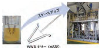
2液相の反応の際、従来の攪拌翼は面積が大きく、液中で液を循環、剪断するため大動力が必要。「WWミキサー」は遠心力を活用して液を液上空間に放出し、異なる場所の
