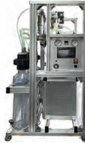
高密度オゾンナノバブル水生成装置は、カーボンセラミックスを用いた超微細気泡発生装置とオゾン発生装置を組み合わせ、超純水中にオゾンのナノバブルを滞留させることで高密度オゾン水を生成する。循環モーターを使わず、酸素ポンプと接続して簡単に高密度オゾン水を作ることができる。
