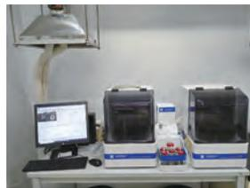
還元気化水銀測定装置「RA-7000Aシリーズ」は前処理から測定までを完全自動化し、作業者の技量や経験に影響されやすい測定精度のばらつきを抑えることができる。特長として、①洗浄工程の改善などで測定時間を大幅に短縮、②廃液量や消費電力量も約30-50%削減した。
