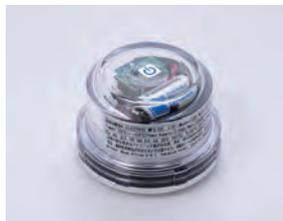
防爆Wi-Fi振動センサー「コナンエアー」は、第一類危険箇所（ゾーン1）にある汎用回転機械や搬送設備の外側に磁石で設置できる加速度や速度を測るセンサー。検出した生データをWi-FiでPCやスマートフォンに送信する。データから異常発生を予測でき、予防保全に役立つ。
