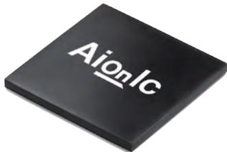
機能を特化したロジックをハードウェアで複数用意し、アプリケーションによって組み合わせることで高性能、低消費電力を実現した人工知能（AI）チップ。プロセッサを何千個も何万個も集積したGPUと、単機能に特化しつつもGPUより高性能なASICの両方の利点を両立させた。監視カメラの中で画像認識を行うといった、エッジデバイスでのAI処理に特化している。
