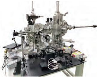
約80ピコ秒（ピコは1兆分の1）の時間分解能を実現した走査トンネル顕微鏡（STM）を開発した。レーザー光をSTMの探針と試料との間に入射して、高速光学手法のピコ秒レベルの高い時間分解能とSTMの原子レベルの高い空間分解能とを組み合わせた。微細化が進む半導体材料を筆頭に太陽電池材料、
