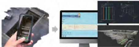
「ちかデジ」は、スマートフォンなどで撮影した掘削工事現場の動画をウェブアプリに投稿することで、動画データを3次元（3D）デジタルデータに変換、表示できる。3Dデータにすることで掘削状況を視覚的に把握しやすくなり、また地図情報プラットフォーム（GIS）で一元管理することも可能になる。手作業でミスが生じやすい仕事をデジタルに置き換え、大幅な生産性の向上が期待できる。
