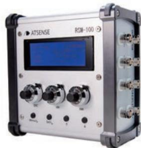
電気自動車 (EV) やハイブリッド車 (HV) といった電動車 (xEV) 用モーターの研究開発向けの計測装置。これまでは難しかった走行用モーターの角度検出に使われるレゾルバ信号を分岐し、走行制御中の駆動モーターの回転角度や速度を計測することが可能で、モーター由来で発生する音や振動、制御の不具合などの解決に威力を発揮する。
