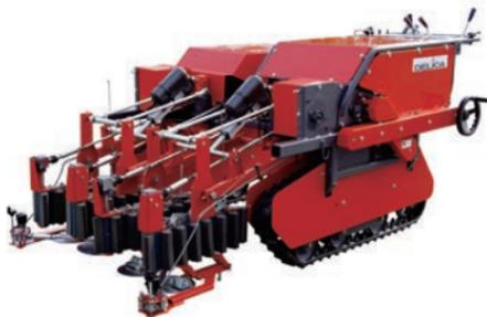
レタス収穫機は走行体と、そこから前方に伸びて上下左右に揺動する2基の刈り取り機構で構成される。2条同時刈り取り機構により、全面マルチ栽培に対応。畝に接する円板ガイドとそれに連動する刈り取り刃により、高速でありながら損失が少ない刈り取りを可能とした。刈り取り部は全面マルチ栽培の2畝を同時に切断するため、コンベヤーを有し独立して上下し、基準となる位置を決める。
