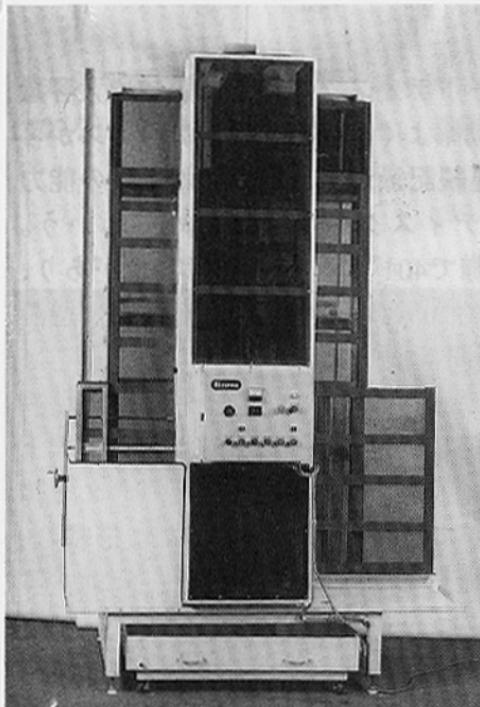
切断が難しいとされていた大型平面板の合わせガラス（ガラスとガラスの間に樹脂を入れたガラス）や網入りガラス、セラミックス系の建材、石材などを高速、高精度で切断する。
