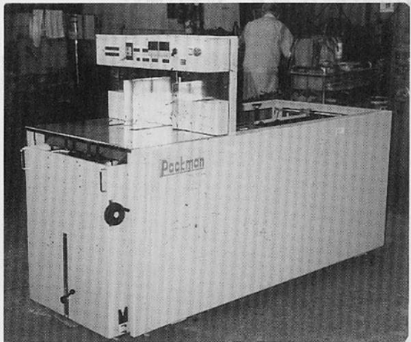
紙はユーザーの多様なニーズに対応できるよう枚葉の包装紙（クラフト紙）を使用し、従来の2倍の速さ（1分間に8個=4人分以上の仕事）で包装できる。サイズチェンジもボタン操作だけで済むため、自動化が遅れていた包装分野の省力化に貢献する。製本業界はもとより、印刷、製紙業界などにも大きな影響を与えそうだ。
