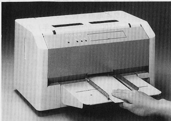
封筒のフランプに折り目を入れ、糊をつけて封かんするだけ。封筒のサイズに関係なく小スペースで簡単に行えるものはなかった。機械に糊をセットしておけば、使用時に糊のキャップが外れ、終了すると自動的にキャップがかかる仕組みで、スイッチを入れればただちに使用できる。手差しの手動式ながら処理速度は長形3号で毎分12枚と速い。
