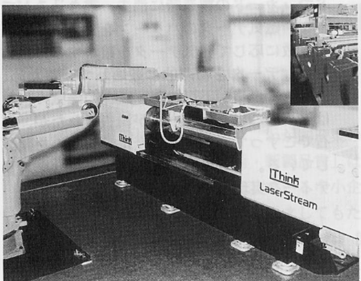
デザイン原稿の作成・編集、デザイン情報のデジタル化のほか、デジタル情報をレーザーで印刷用シリンダーに焼き付けたり、現像処理、排水のクローズド化など一連の工程を無人運転で行うシステムにまとめた。文字画像の品質なども大幅に改善しているうえ、従来、1週間を要していたグラビア製版工程がわずか1日ないし3日程度に短縮可能になったことから内外の企業が導入している。リピートオーダーも多い。
