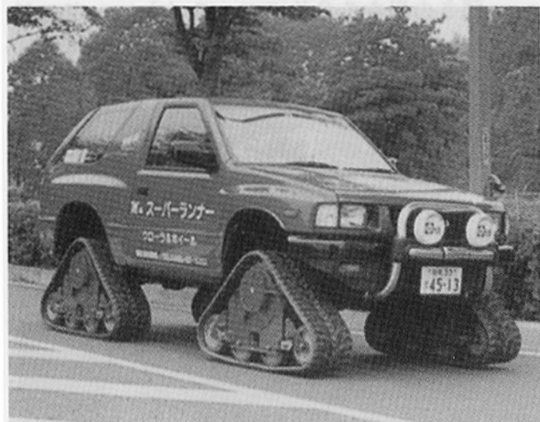
4駆のRVのタイヤの代わりに新開発の4輪独立のオムスピ型ゴムクローラユニットを装着した車。雪、砂、泥だらけの軟弱地、急坂といった通常のタイヤでは不可能のところでも安定して優れた走破性を持つ。積雪時にもタイヤチェーンは要らない。
