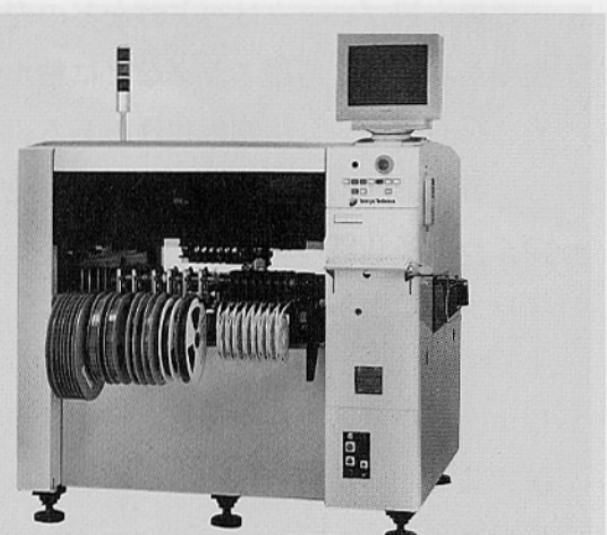
この結果、1部品当たりの実装時間を0.195秒と大幅に短縮、実装コストの低減を図ったほか、部品は中速実装機では最多の120種まで装着可能だ。携帯情報機器など電子機器の小型化、高性能化、低コスト化が進んでいる中で要求されているマウンター（表面実装部品装着機）の高速化を実現した。
