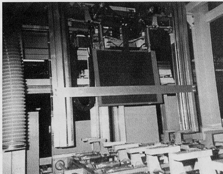
プリント基板は1枚ずつ搬送され、かつ通電ラックは複数のメッキを行う場合でも処理薬品専用の治具で特定の処理のみを行い、異種処理液には、自動的に次の専用治具に処理パネルを受け渡して処理液のコンタミネーションを防ぐ。メッキ液は搬送の間にスポンジローラーで絞り取った後でスプレーで水洗するため、メッキ液の外部への排出が少ない。ブラインドビアホールや細孔メッキのスローイングパワーに優れ、メッキ膜厚は均一で、処理速度は通常の3～5倍が可能。
