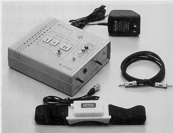
生体信号のうち、眼電信号または脳波を検出し、この信号を変換して電気的な制御信号として出力する。このため、身体や眼球さえ全く動かすことなく各種の機器を操作できるようになる。額部で電気的に検出した眼電信号または脳波信号を特殊増幅し、スペクトルデータに変換。このデータとプリセットデータを独自開発の演算式でデジタル比較し、その結果によって汎用的な電気信号に出力する仕組み。パソコンなどと直接接続するためのシリアルポートを標準装備。
