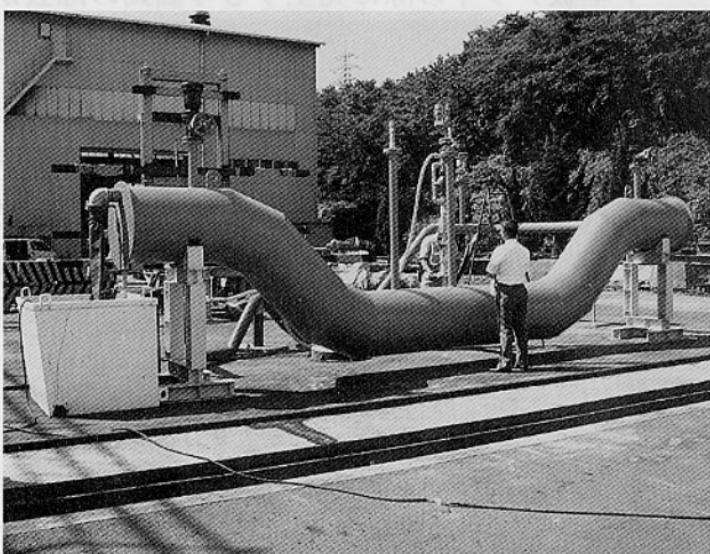
これに対してこの装置は、配水本管の要所を垂直下方のU字形状の曲管にして、ここに用水を常時貯留させておき、緊急時に備える。震災時に本管や曲管の先端が破壊されても貯留水は流出せず、また配水本管の一部を用水の貯留に利用するため、地上の用地の確保を必要としない。公道下に設置するため、設置工事も配水本管敷設工事と同時に可能。
