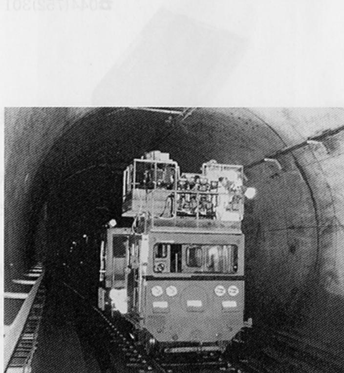
コンクリート構造物の表面をビデオカメラで撮影し、画像処理技術によりひび割れの分布、長さや幅を定量的に検出するシステム。
