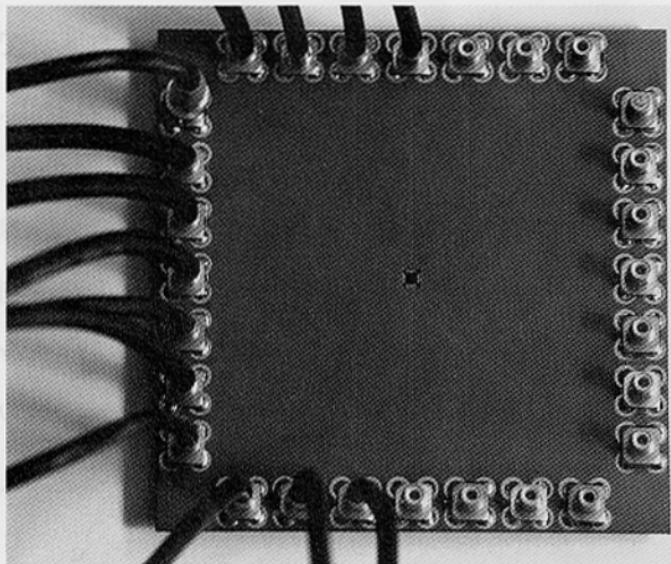
高速化する半導体素子開発時の微細な特性測定に大きな効果を發揮する同軸配線基板。
