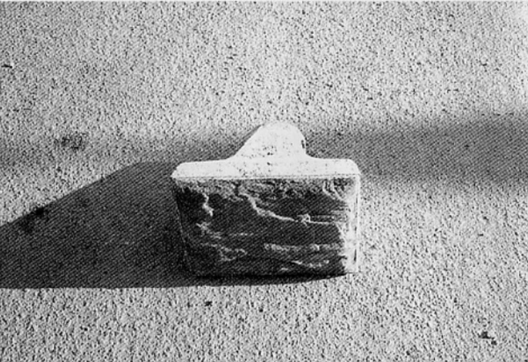
バイオマス系廃棄物を炭化物としてコンクリートに複合して造った河川などの護岸・魚巣用ブロック。
