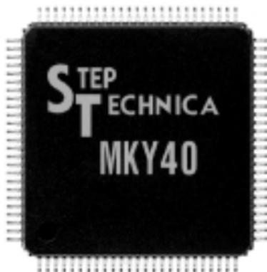
複数のマイコン間でデータの伝送や交換をリアルタイムに容易かつ高速に行えるデータコミュニケーションLSI。サイクリックな通信によりマイコン間で一つのメモリを共有することで、信号電線を大幅に削減することができるようになった。
