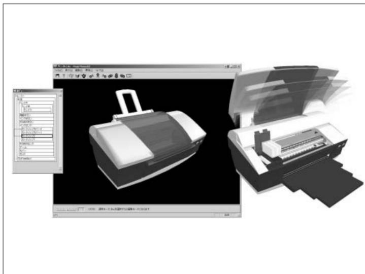
CADや3次元モデリングソフトで作成したデータを読み込み、その形状データに動作を定義することによってコンピューターの画面上で立体模型の組み立てや分解手順が表現できる3次元コンテンツを容易に作成するソフトウェア。
