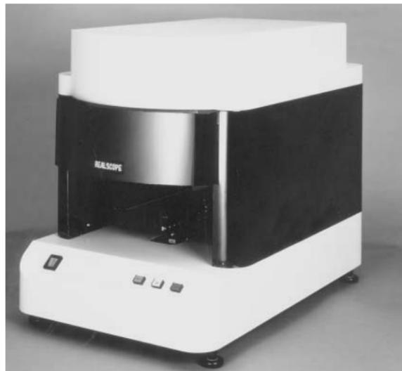
プリント基板への部品実装の品質を自動検査する装置。従来の検査機とは異なり、はんだを斜め方向から立体視するため、無鉛はんだで生成される平面形状に固化されたはんだでも正確かつ容易に良・不良判定ができる。また、有鉛はんだでも従来機では検出不能とされていた電極浮き不良を直接的に検出して正確に判定できる。
