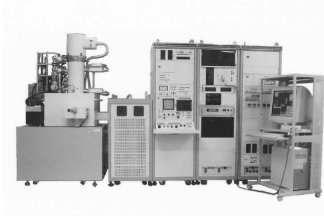
加速電圧100kVおよびジルコニアタンゲステン熱電界放射型電子銃の採用により、最小ビーム径1.8nmの極細線ビームを長時間安定して使用できるため、10nmオーダーの細線も従来よりも容易かつシャープに描画できる。電子線のエネルギーを対象物の任意の位置で局所化された微小領域に集中させるため微細加工分野への新たな用途が期待できる。
