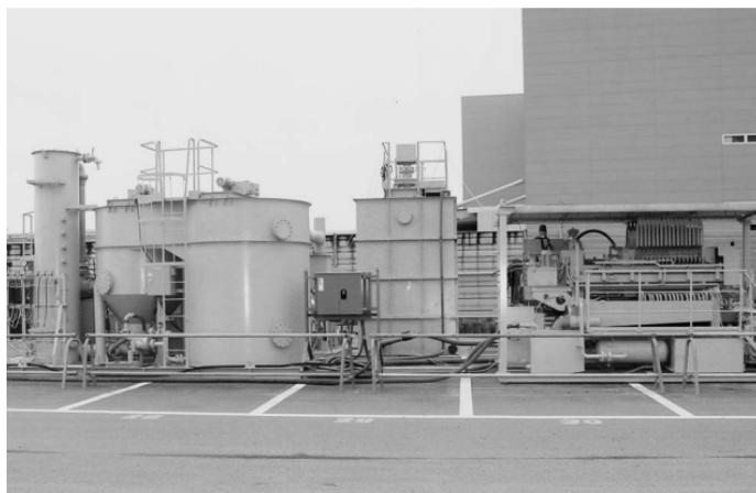
土壤内の揮発性有機化合物（VOC）や重金属を洗浄するウォータージェットの超高压水による地層汚染曝気（ばっき）洗浄工法。
