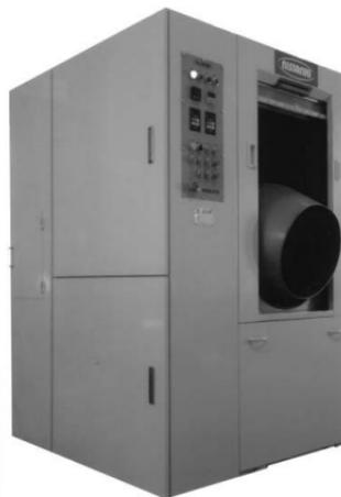
水とメディアを混合させ高速回転ホイールで広角的に投射することで、粉塵の発生がないクリーンな環境で短時間に洗淨・ブラストする装置。
